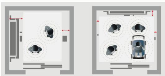
Optimierte Schachtbauteile und genau anpassbare Kabinenmaße ermöglichen beim Schindler 6200 mehr Platz in der Kabine. Das bedeutet höhere Nutzlasten und mehr Komfort für die Aufzugsnutzer. (Foto: Schindler Deutschland)
