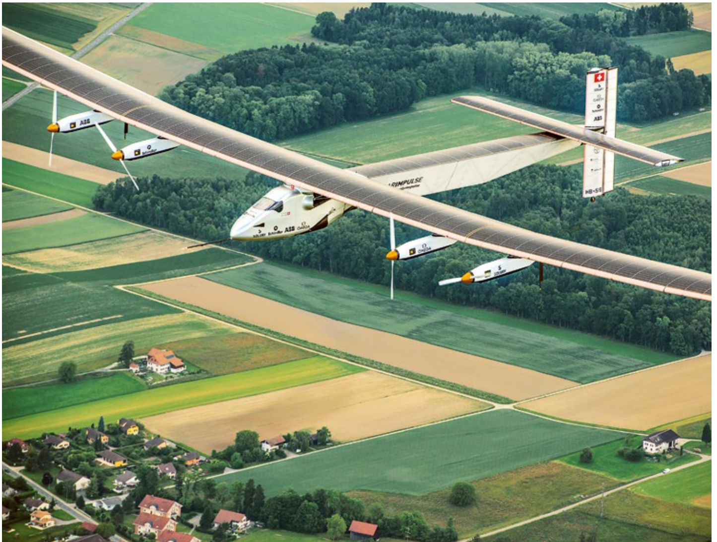
Lichtgestalt: 17 248 Solarzellen bilden die Oberfläche der Solar Impulse 2.
